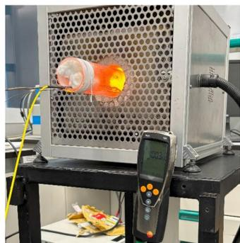
Montaje experimental en el horno tubular
